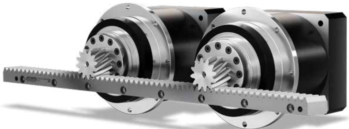
Mehrfachzahneingriff zur elektronischen Verspannung Multiple pinion contact for electronical preload
